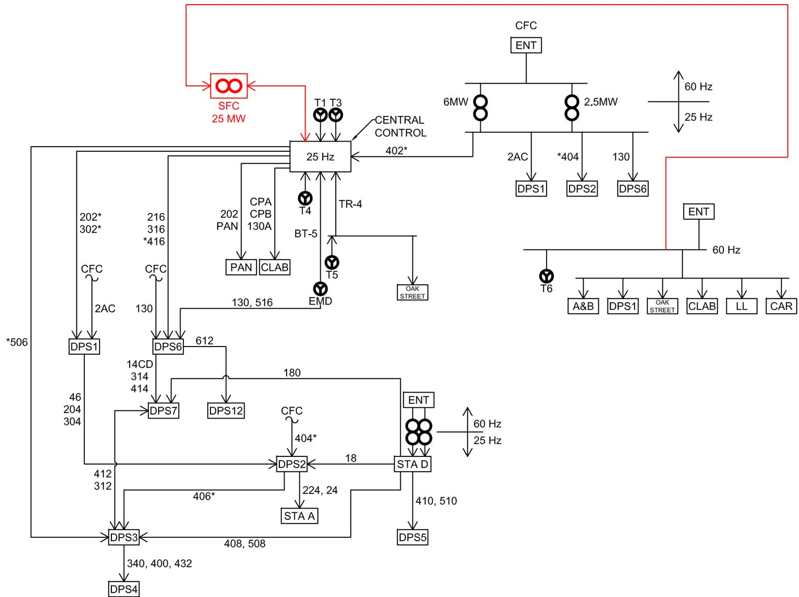
FIGURE 3 - STATIC FREQUENCY CHANGER (SFC) ADDITION COMPLETE
